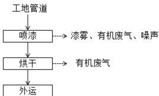
图 2-5 生产工艺及产污环节图
