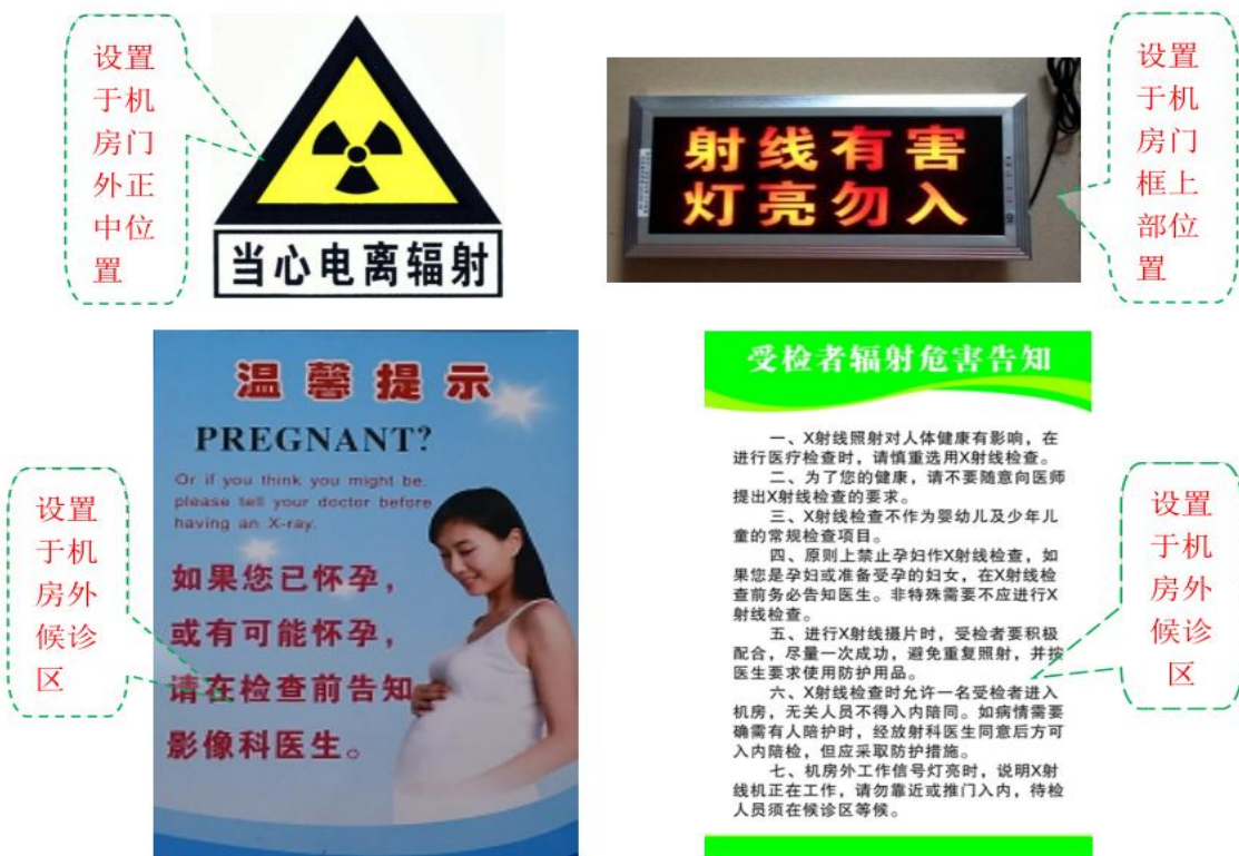
图 10-4 警示设施样例图
