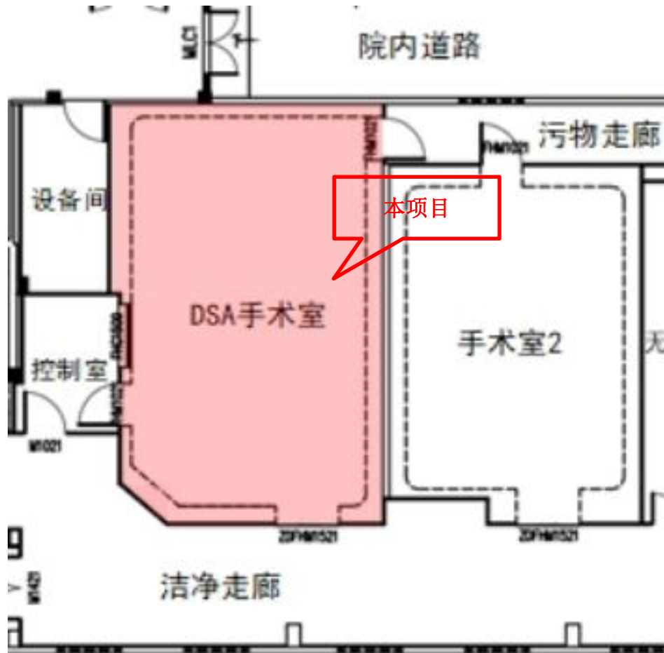
图 1-4 项目所在 DSA 介入手术室平面布置图
