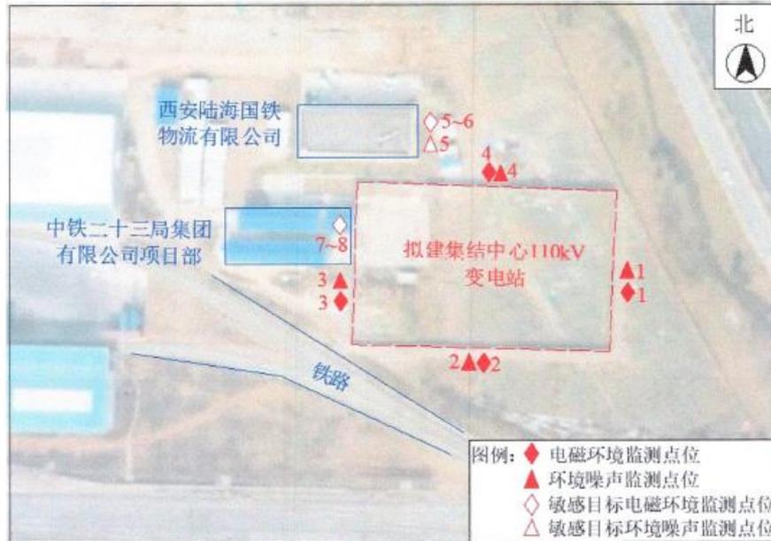
图 3-1 拟建集结中心 110kV 变电站及周围敏感目标监测点位示意图
