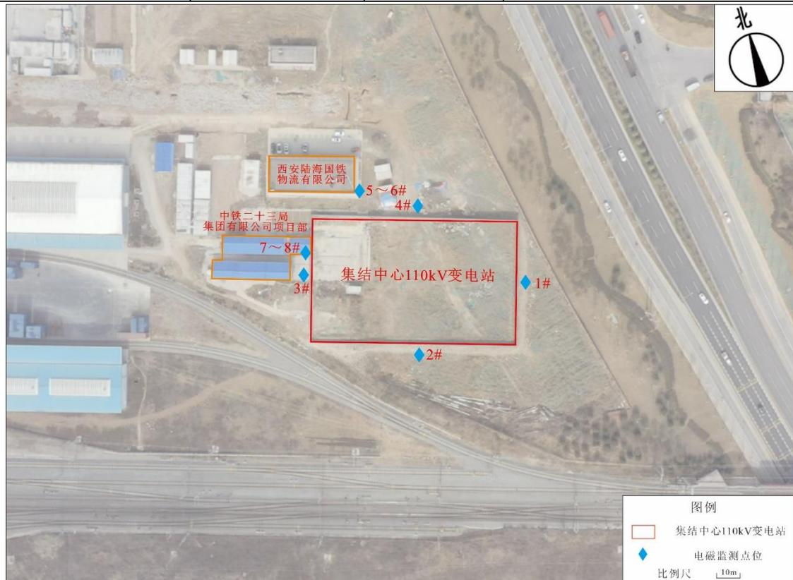
图 1 工程电磁环境监测点位示意图 1
