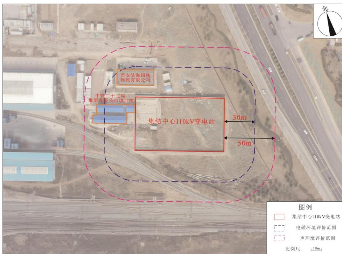
图 3-5 拟建西安集结中心 110kV 变电站评价范围与环境敏感目标位置关系图
