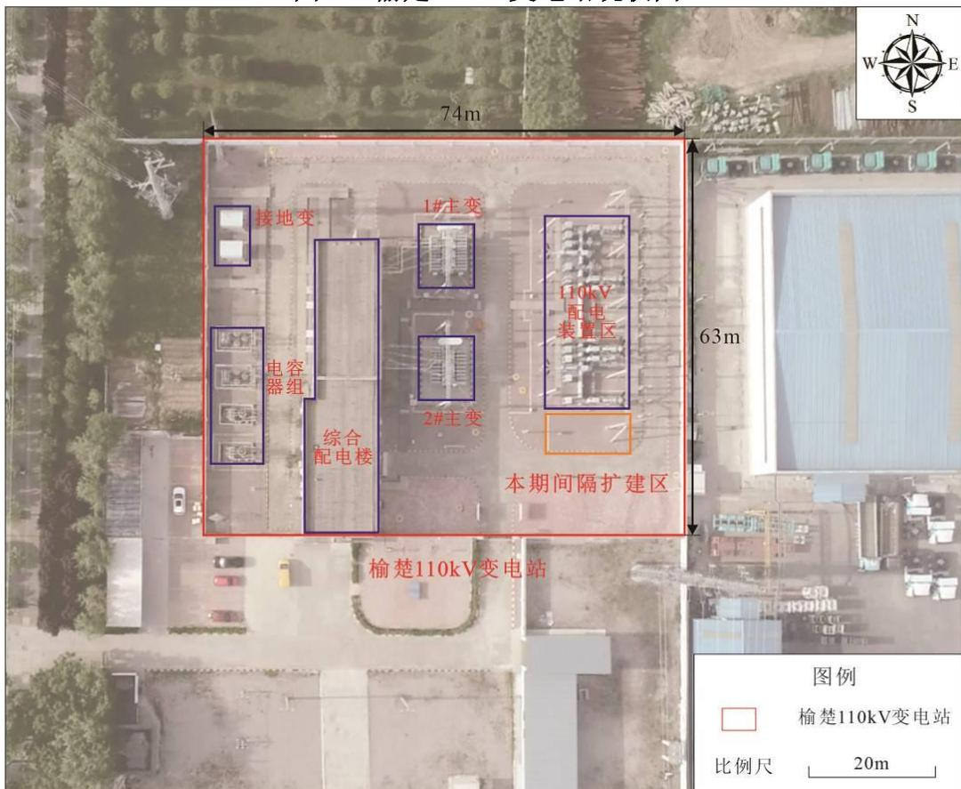
图2-4 榆楚110kV变电站平面布置及间隔扩建示意图
