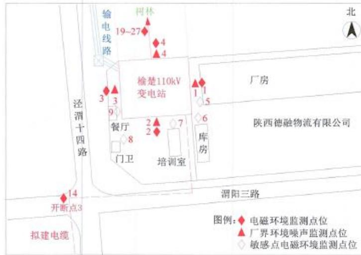
图 3-1 榆楚 110kV 变电站四周厂界及周围敏感目标、电缆沿线监测点位示意图
