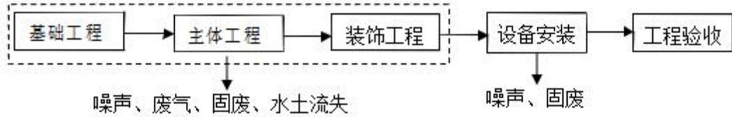
图 1 施工期工艺流程及产污环节图
