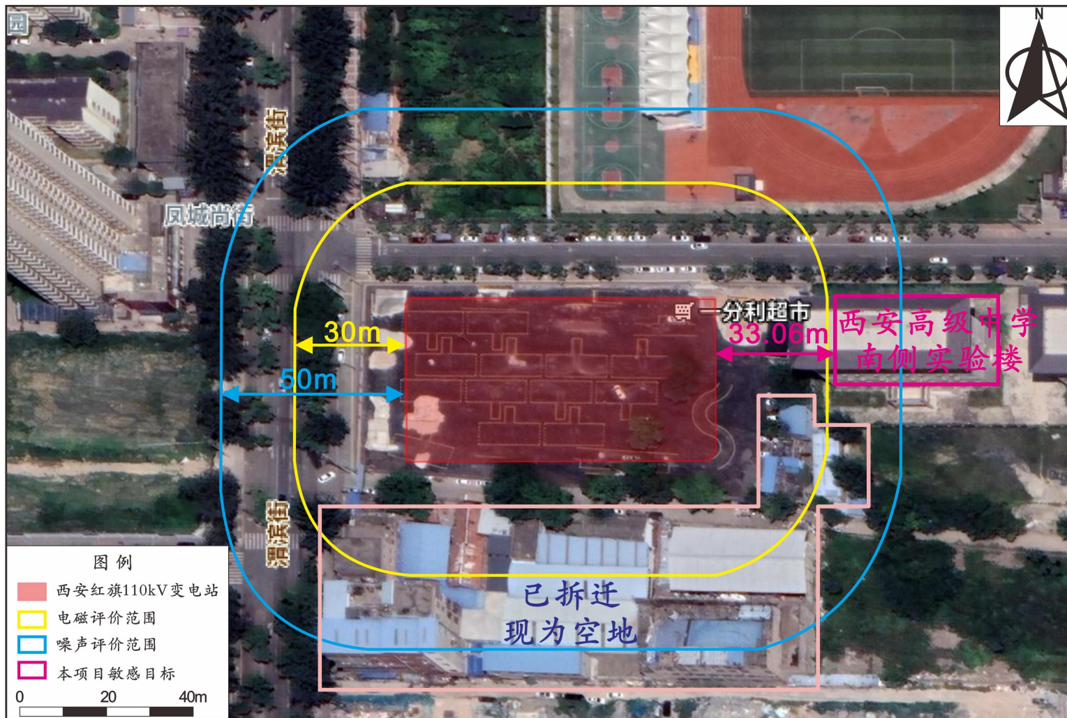
图 3-9 西安红旗 110kV 变电站电磁、噪声评价范围及变电站与周围环境敏感目标位置关系图
