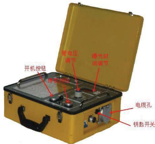
图 9-3 X 射线探伤装置控制箱
