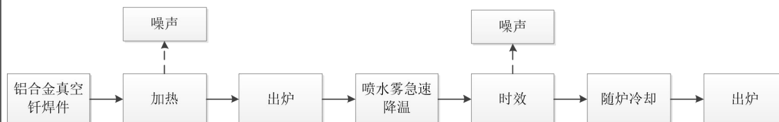
图 2-2 运营期工艺流程及产污环节图
