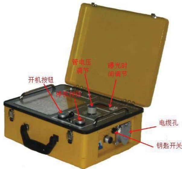
图 9-3 X 射线探伤装置控制箱
