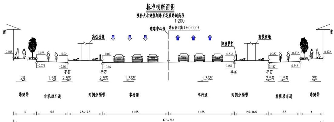
图2-5 陕科大北侧规划路至花辰路超高段标准横断面图
