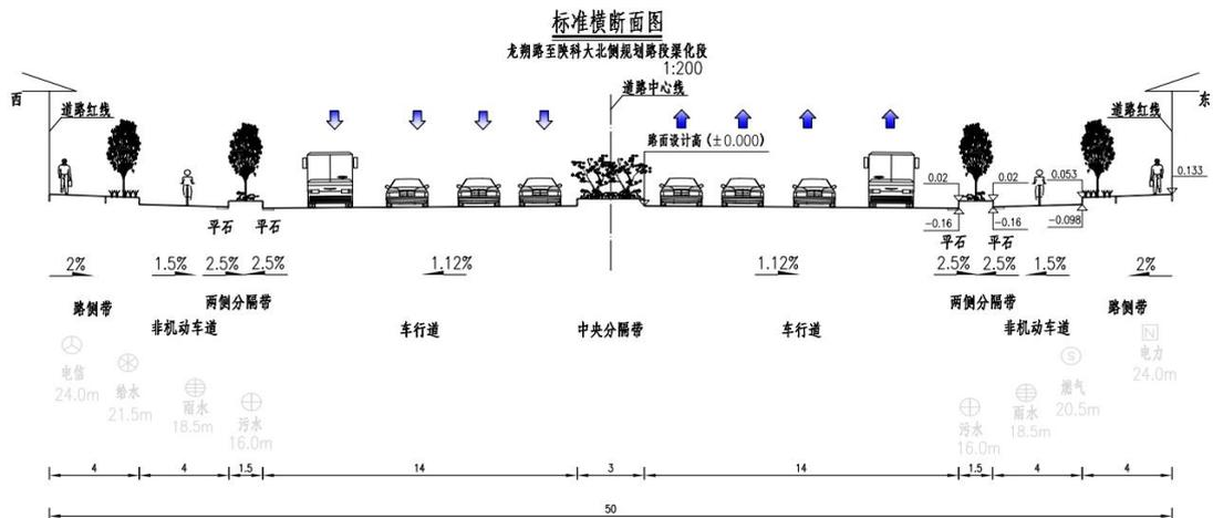
图2-3 龙朔路至陕科大北侧规划路段渠化段标准横断面图
