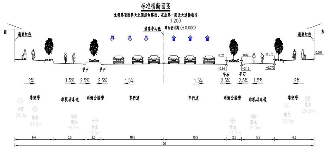
图2-2 龙朔路至陕科大北侧规划路段、花辰路至阳光大道标准段标准横断面图
