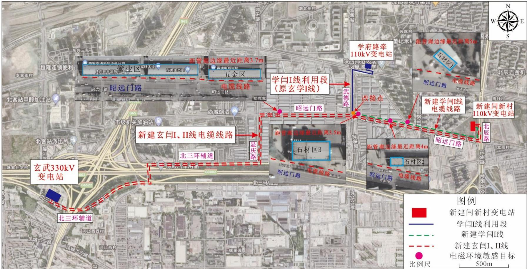
图 3-9 新建 110kV 电缆线路与环境保护目标位置关系示意图
