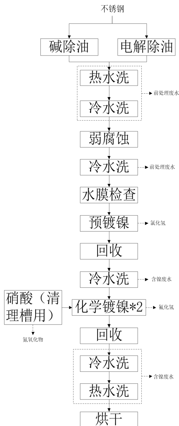
图 3.2-8 化学镀镍自动生产线工艺流程及产污环节图
