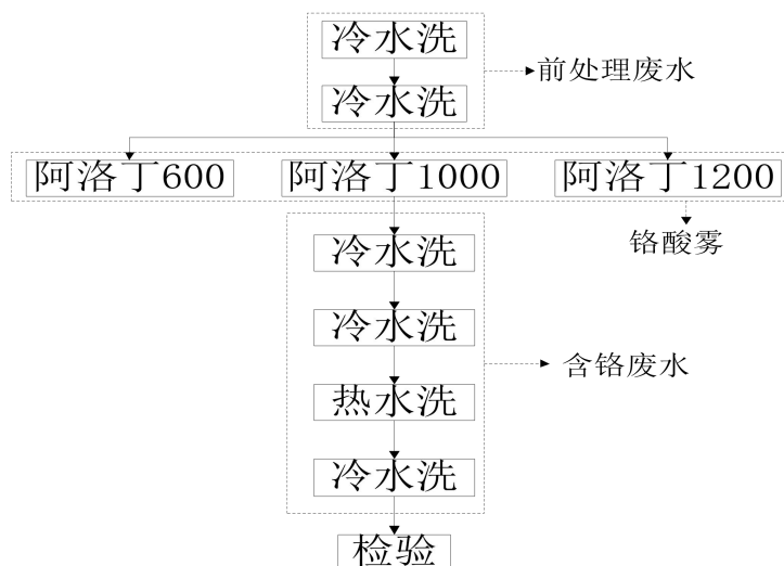
图 3.2-4 阿洛丁自动生产线工艺流程及产污环节图
