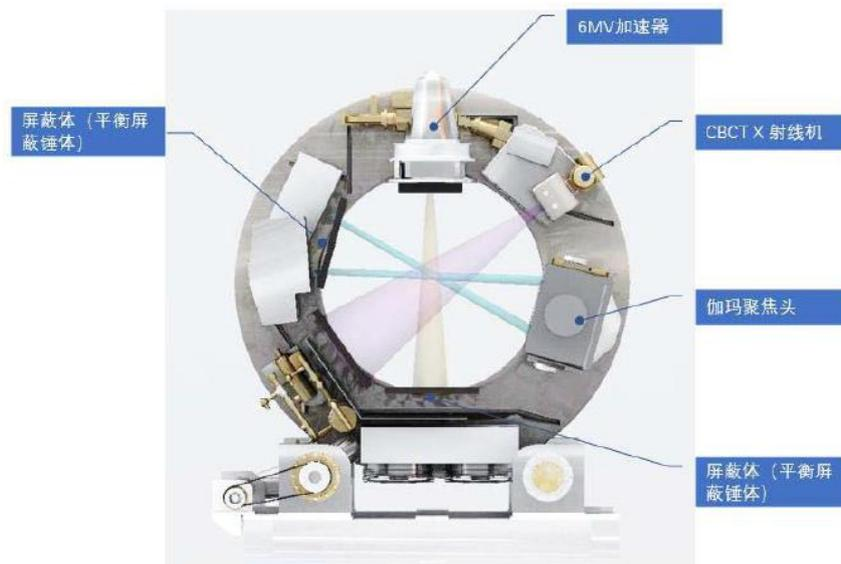
图 9-1 TaiChi 系列多模式一体化数码放射治疗系统产品（包含加速器和 CBCT）示意图
