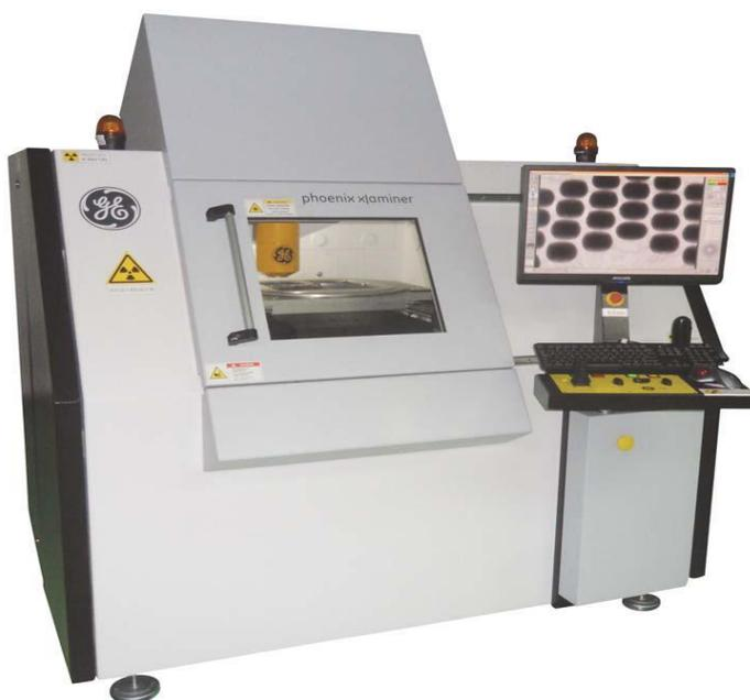
图 1-1 phoenix x|aminer 高功率 X 射线检测系统外观示意图
