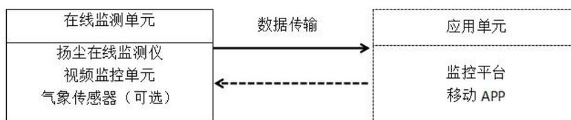
图 1 扬尘在线监测系统组成示意图
