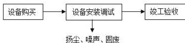
图5-1 项目施工期工艺流程及产污环节图
