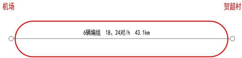
图 2.1.1-5 西安地铁十四号线列车运行交路图
